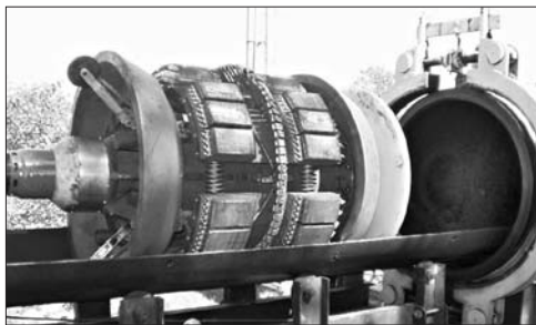
3. Інтелектуальний поршень для виявлення пошкодження трубопроводу
